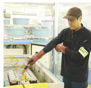
十分な絶縁耐力があるか、最後に耐圧試験を行う
